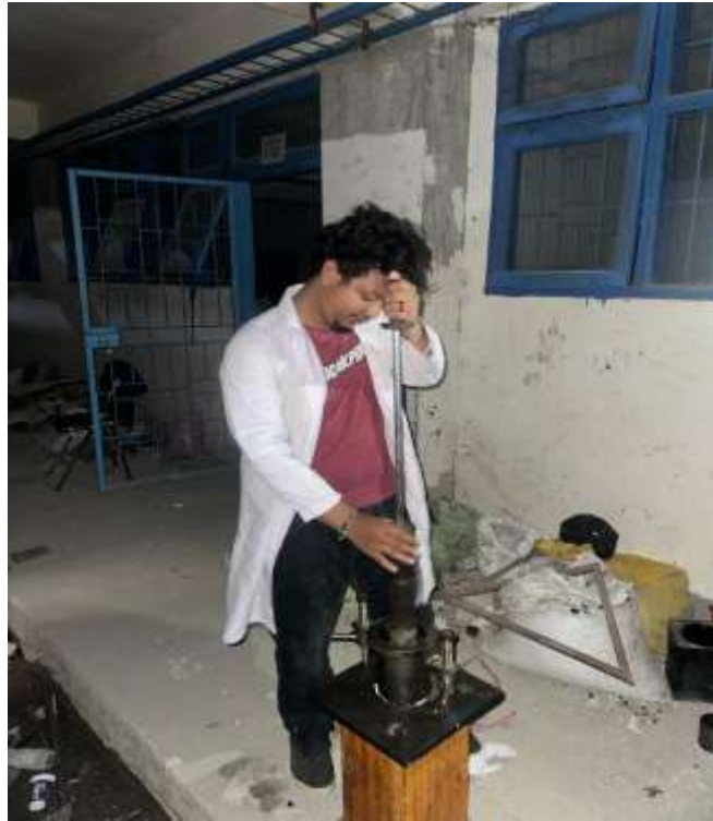
Proses penumbukan benda uji
