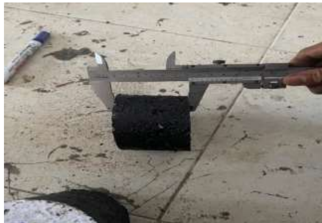
Mengukur tebal briket
