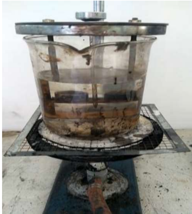
Pengujian titik lembek
