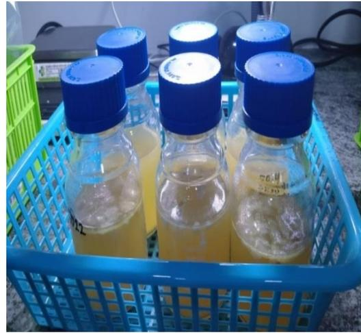
Gambar 4 Pencampuran Sampel Dengan Larutan BMW
