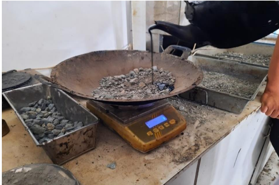
Proses Pencampuran Agregat dengan Aspal
