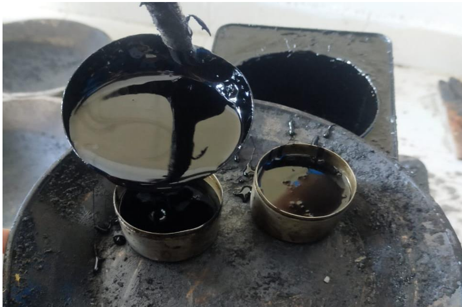
Proses Pengisian Aspal ke Tinbox
