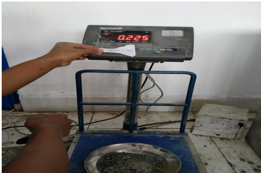
Proses penimbangan abu batu setelah oven
