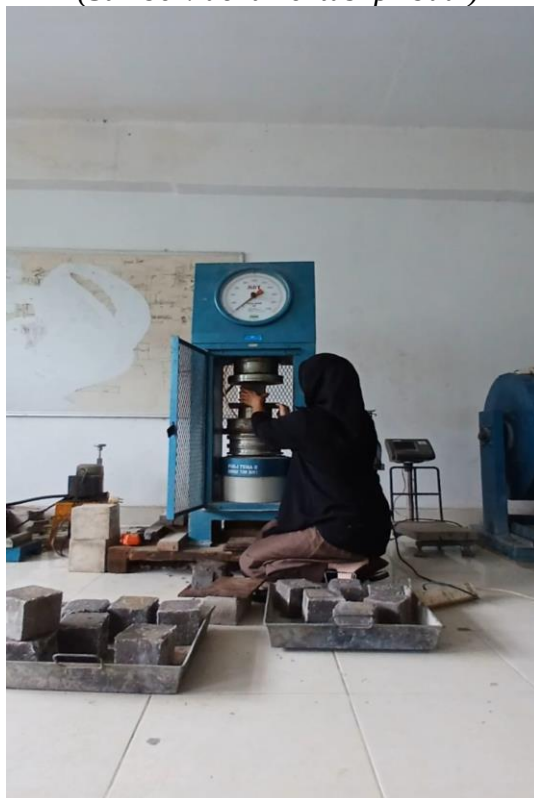
Uji kuat tekan beton ringan (Sumber: dokumentasi pribadi)
