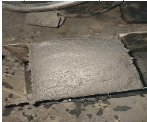
Proses terjadinya pengembangan adonan pada beton ringan (Sumber: dokumentasi pribadi)
