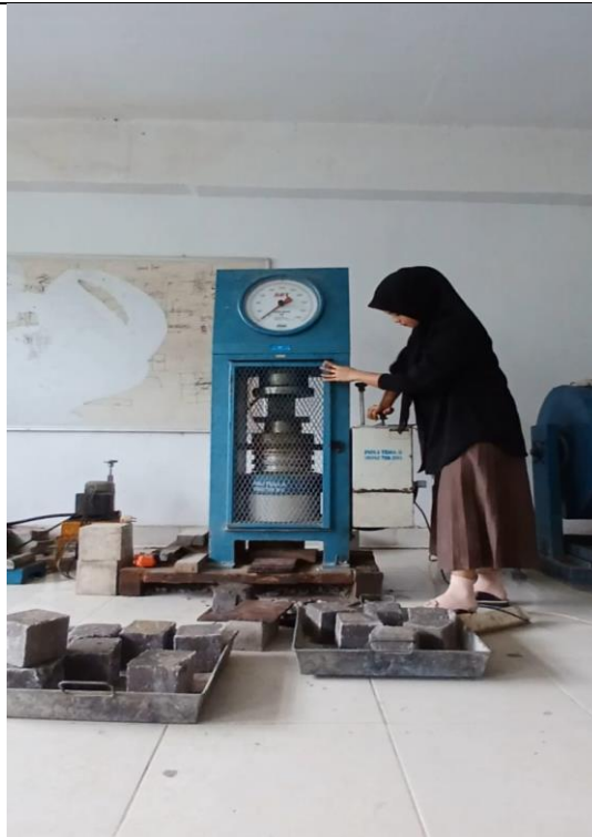
Uji kuat tekan beton ringan (Sumber: dokumentasi pribadi)
