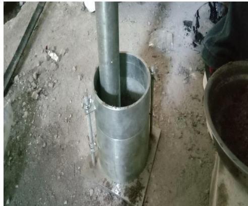
Proses pemadatan (Sumber: dokumentasi pribadi)
