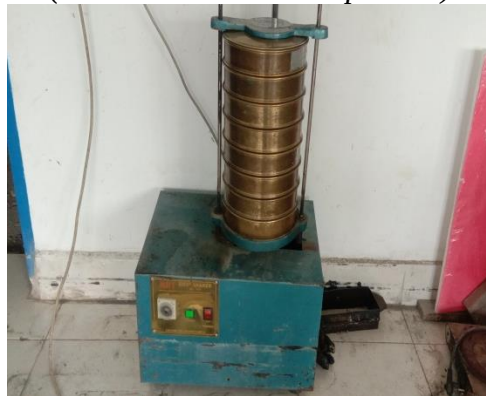
Mesin pengguncang saringan (Sumber: dokumentasi pribadi)
