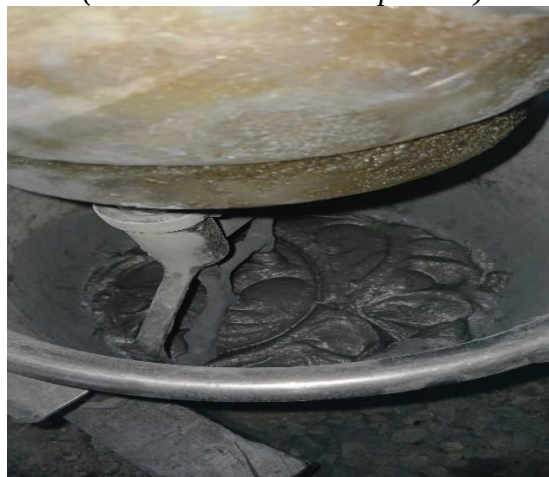
Proses pencampuran material (Sumber: dokumentasi pribadi)
