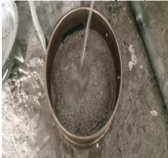
Proses pembuangan lumpur pada pasir (Sumber: dokumentasi pribadi)
