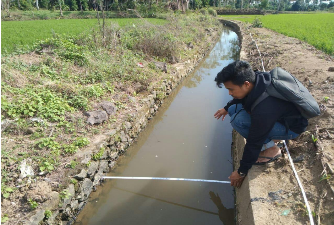
Pengukuran Lebar Saluran Tersier
