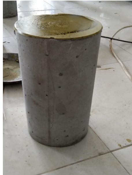
Pengujian kuat tekan beton
