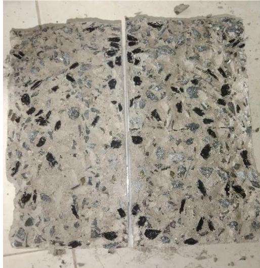
**Gambar 4. 7** Gambar tarik belah Limbah Beton 25%+ Serat Bambu 1,5%
