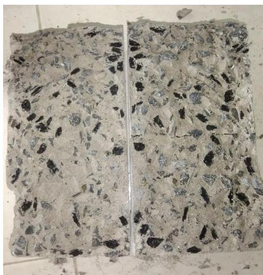
**Gambar 4. 6** Gambar tarik belah Limbah Beton 25%+ Serat Bambu 1%
