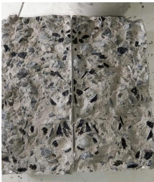
**Gambar 4. 4** Gambar Tarik belah limbah beton 25%
