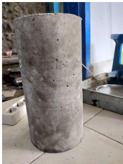
Gambar 3. 1 Benda uji selinder 300 mm × 150 mm (Sumber: Dokumentasi pribadi di Laboratorium struktur dan bahan Universitas Muhammadiyah Parepare)
