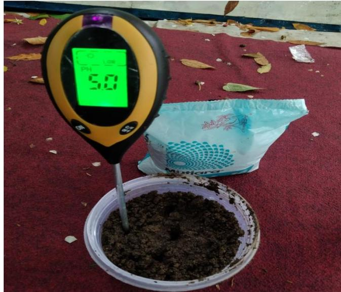
**Gambar 6.** Pengukuran Kalibrasi pH Tanah
