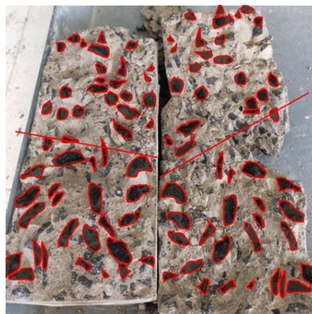
Gambar 4 : Tarik belah beton 2 jam pembakaran
