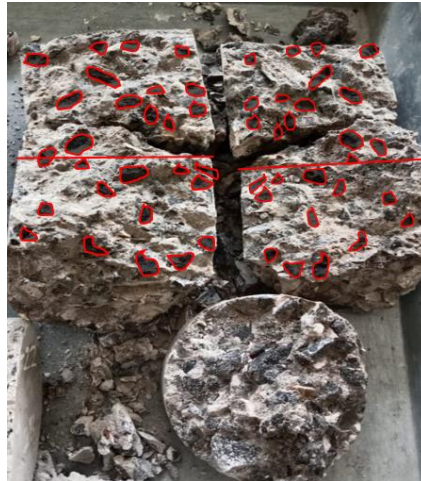
Gambar 5 : Tarik belah beton 4 jam pembakaran
