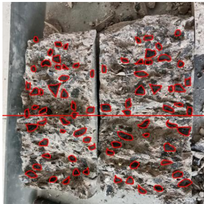
Gambar 6 : Tarik belah beton 6 jam pembakaran
