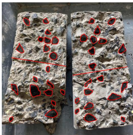
Gambar 3 : Tarik belah beton normal
