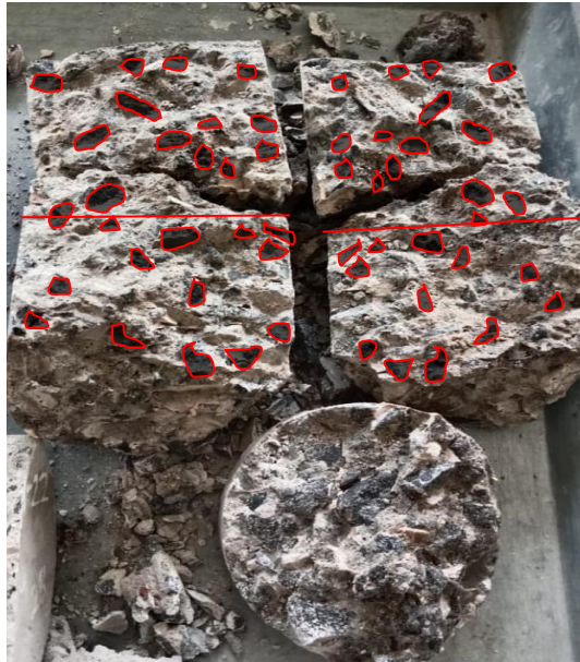
Gambar 4.4 Tarik belah beton 4 jam pembakaran
