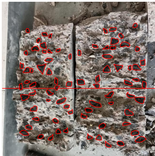
Gambar 4.5 Tarik belah beton 6 jam pembakaran
