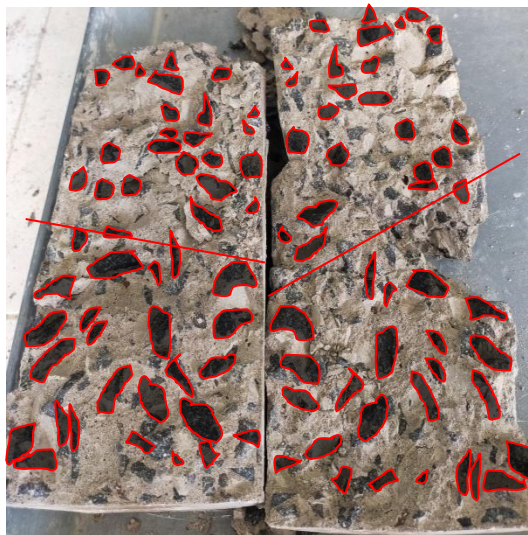
Gambar 4.3 Tarik belah beton 2 jam pembakaran
