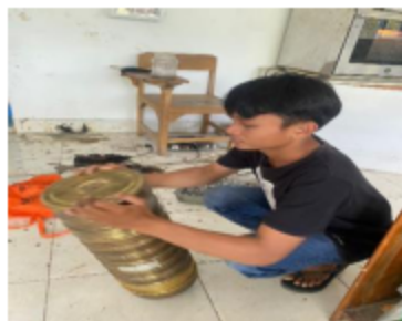
Proses penyaringan agregat
