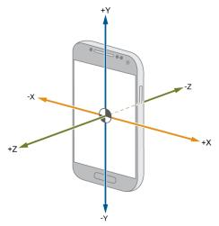
Gambar 2. 2 Ilustrasi Accelometer di Smartphone
