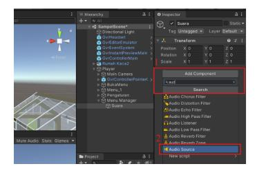
Gambar 4. 88 Proses pembuatan audio click pada button
