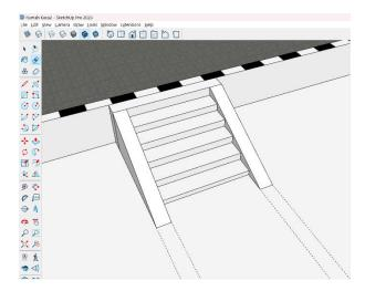
Gambar 4. 27 Proses detailing anak tangga
