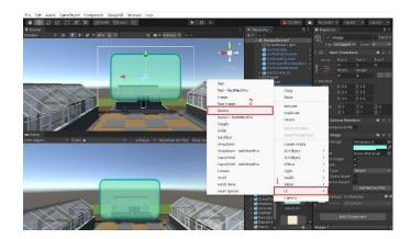
Gambar 4. 83 Proses pembuatan Button
