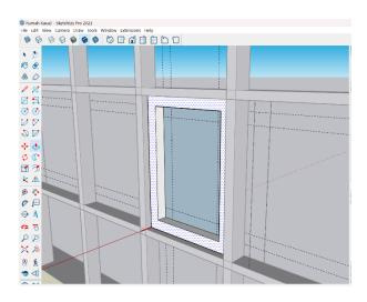
Gambar 4. 45 Proses pembentukan 3D pada jendela
