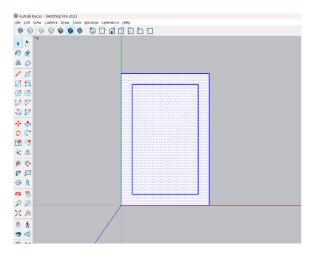
Gambar 4. 32 Proses Melakukan Make Component
