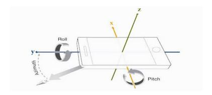
Gambar 2. 3 Ilustrasi Gyroscope di Smartphone
