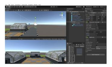
**Gambar 4. 67** Proses Add Componen Rigibody pada *Object* player
