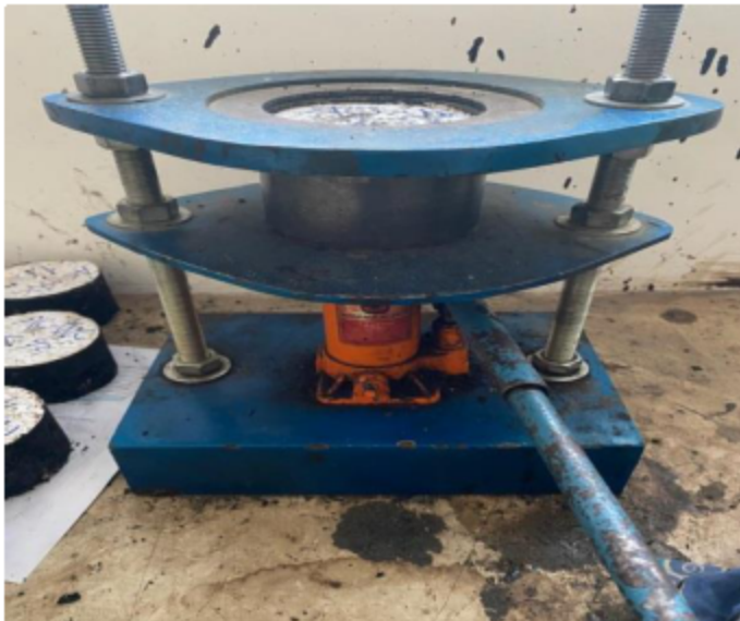
MENGELUARKAN SAMPEL DARI CETAKAN
