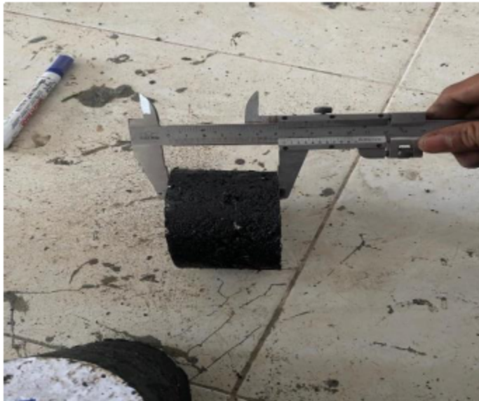
PENGUKURAN KETEBALAN SAMPEL
