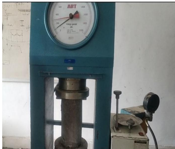
Gambar 2.3. Pengujian Kuat Tekan Pada Beton Sumber : Dokumntasi contoh pengujian kuat tekan beton
