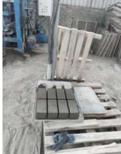
Hasil pembuatan Menggunakan mesin press paving block balok Sumber: dokumentasi pribadi
