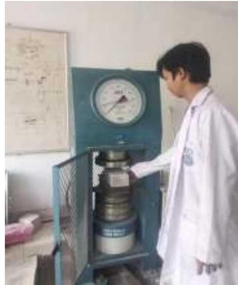
Uji kuat tekan paving block balok variasi 20%
