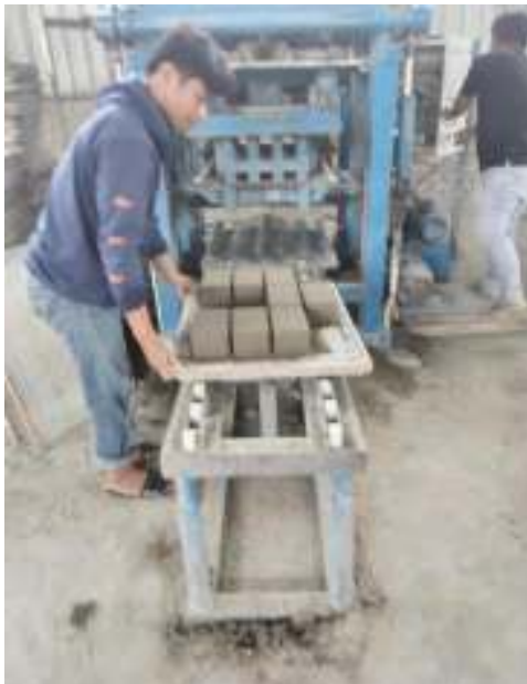
Pembuatan paving block hidrolik Sumber: dokumentasi pribadi
