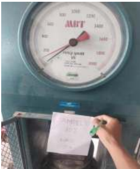
Uji kuat tekan paving block kubus variasi 10%
