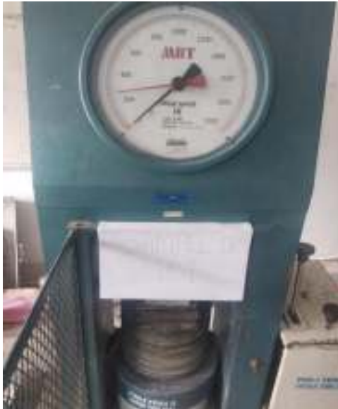
Uji kuat tekan paving block balok variasi 10%
