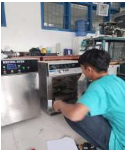
Memasukkan agregat halus ke oven selama 24 jam Sumber: dokumentasi pribadi
