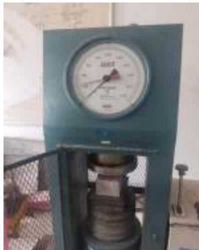
Gambar 4.2 Uji kuat tekan paving block Sumber: dokumentasi pribadi
