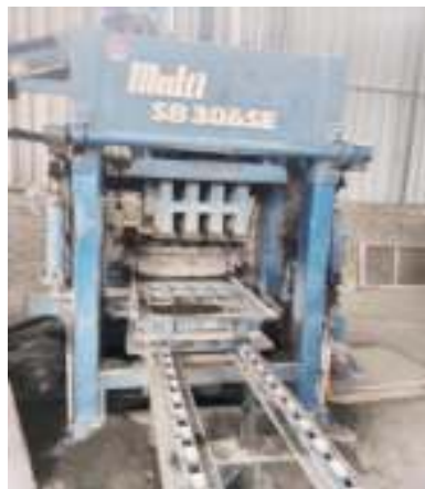
Gambar 3.6 Mesin press hidrolik multi block SB 306
