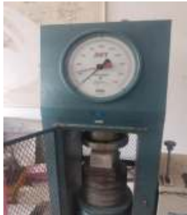
Gambar 3.7 Mesin compression test Sumber: dokumentasi pribadi
