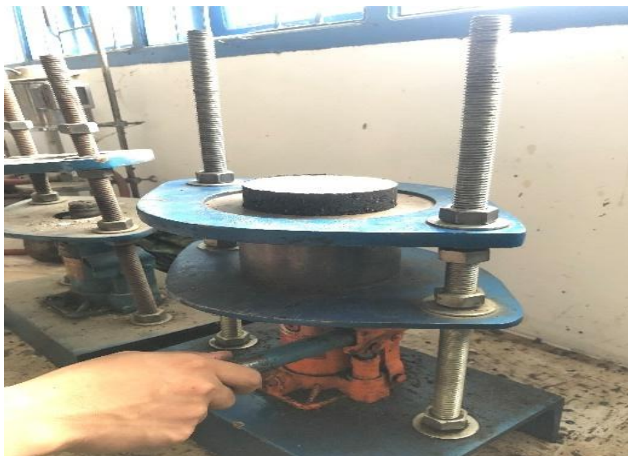
Mengeluarkan sampel dari cetakan
