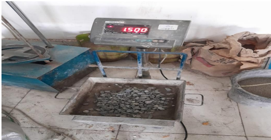
Pengujian analisa saringan
