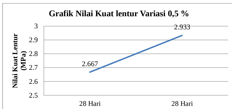
Gambar 4.3 Grafik pengujian kuat lentur beton variasi 0,5%.
