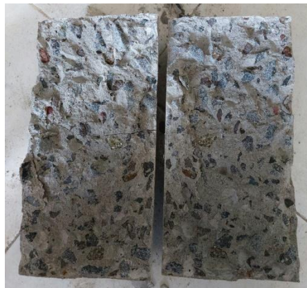
Gambar 4. 9 Gambar Tarik Belah Beton Normal (Sumber : Dokumentasi pribadi)
