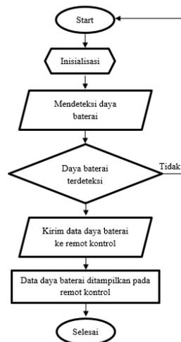
**Gambar.8.** Flowchart perangkat lunak pendeteksi daya baterai
