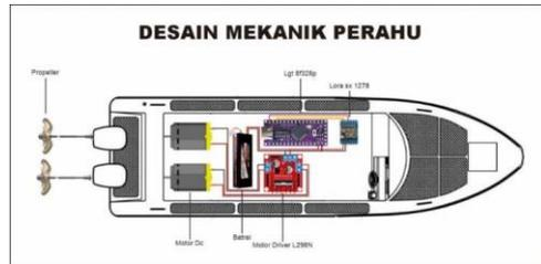
Gambar 3. Rancangan 3d Desain Mekanik Perahu
