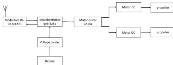
Gambar 1. Blok Diagram Desain Sistem Penggerak Perahu
