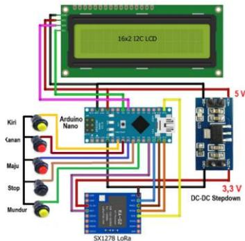
**gambar 5.** Rangkaian Pengontrol Kendali Perahu.
