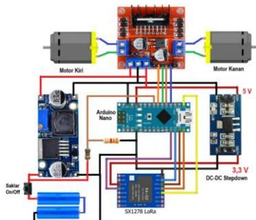
**gambar 6.** Rangkaian Penggerak Perahu.
