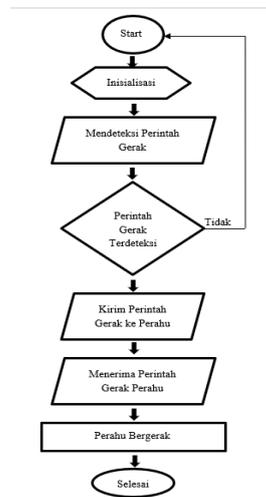
**Gambar 7.** Flowchart perangkat lunak penggerak perahu
