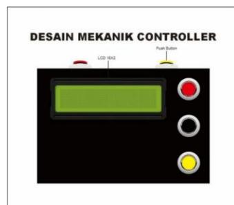
Gambar 4. Rancangan 3D Desain Mekanik Kontroller
