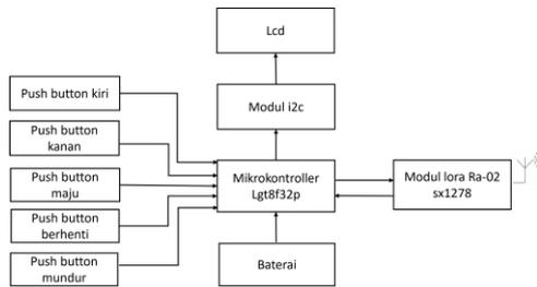
**Gambar 2.** Blok Diagram Desain Sistem Kendali Jarak Jauh
