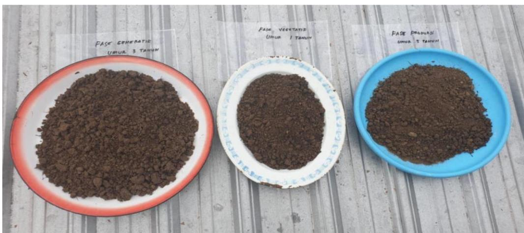
Lampiran 5. Gambar pengeringan sampel tanah masing-masing fase pertumbuhan tanaman kelapa sawit
