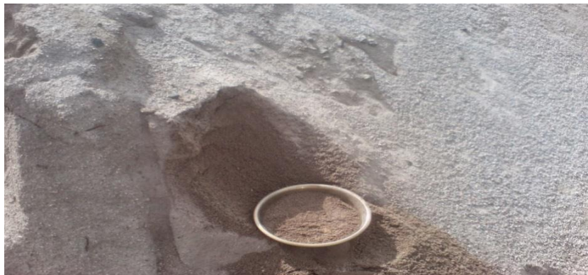
Gambar 2.3 Agregat Halus ( Dokumentasi pribadi )
