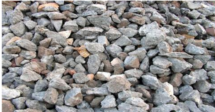
Gambar 2. 2 Agregat Kasar Sumber: (Dokumentasi pribadi)
