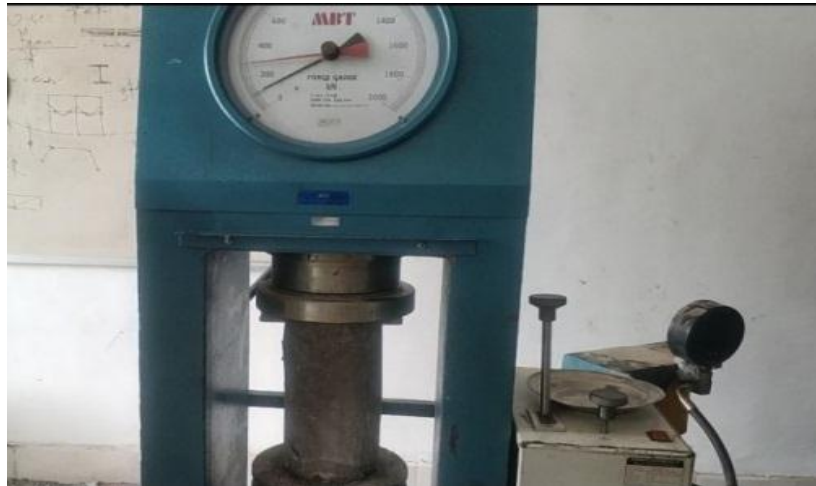
Gambar 2. 5 Pengujian kuat tekan pada beton
