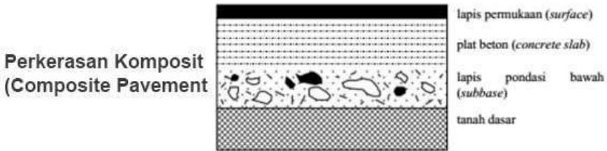
Gambar 1.3. Tipe Perkerasan Komposit Composite Pavement .
