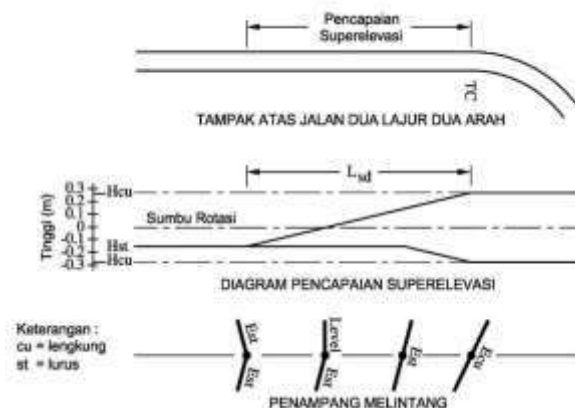
Gambar 3.1. Pencapaian Superelevai (Sumber : Direktorat Jenderal Bina Marga)
