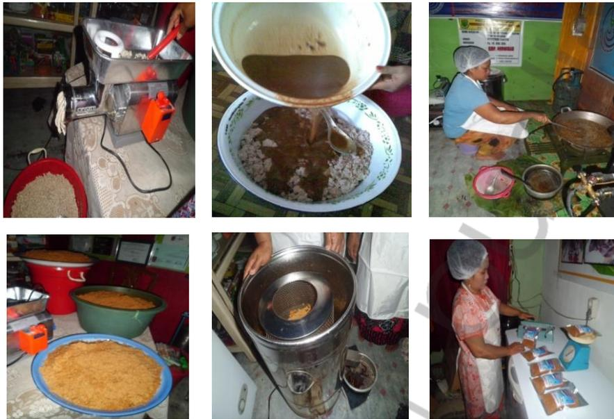
Gambar 2. Tahapan Proses Produksi Abon Ikan Sampai pada Tahapan Pengemasan
