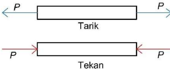
Gambar 8.12. Gaya aksial yang terjadi pada penampang balok
