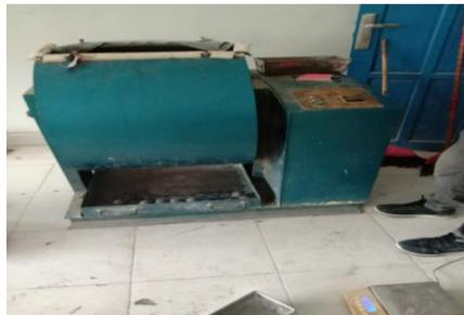
**Gambar 15.** Los angeles (sumber: laboratorium struktur dan bahan)
