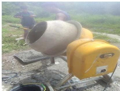
**Gambar 16.** Mixer (sumber: laboratorium struktur dan bahan)
