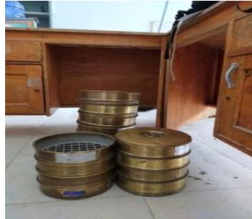
**Gambar 11.** Ayakan saringan (sumber: laboratorium struktur dan bahan)
