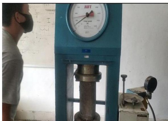
**Gambar.3.** Pengujian Kuat Tekan Pada Beton
