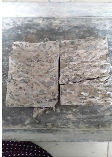
**Gambar 7.** Tarik belah beton campuran pasir pantai 100%
