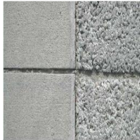
Gambar 2. Perbedaan Tekstur Permukaan Beton Berpori Dengan Beton Normal (Sumber: FloridaConcrete&ProductAssociation)
