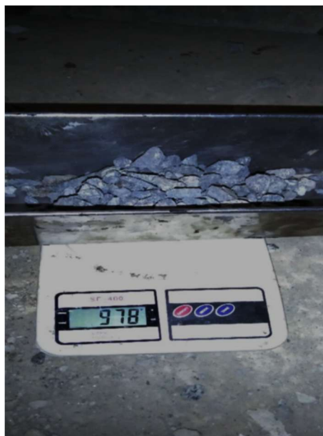
Pemeriksaan kadar air agregat
