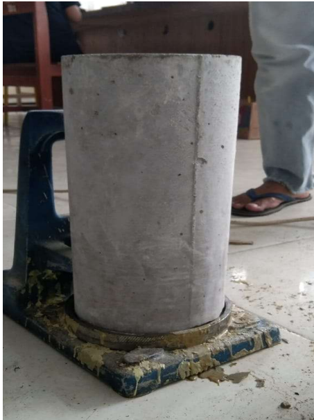
Pengujian kuat tekan beton
