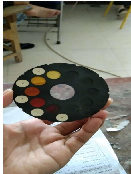
Pemeriksaan kadar organik agregat halus pasir
