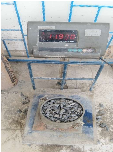
Pemeriksaan kadar air agregat
