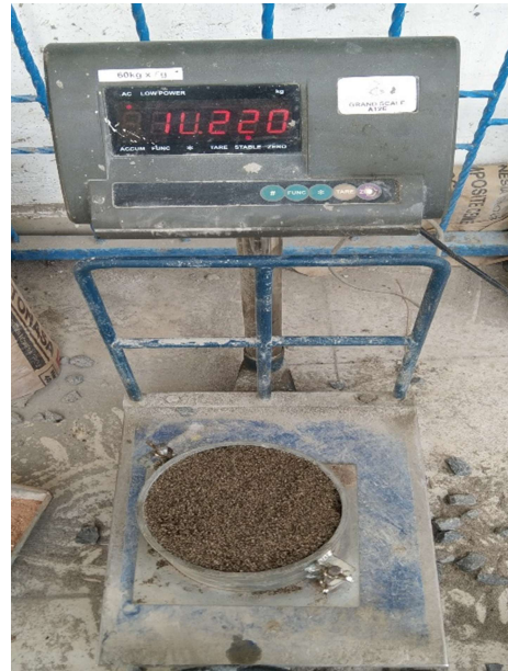
Pemeriksaan kadar air agregat
