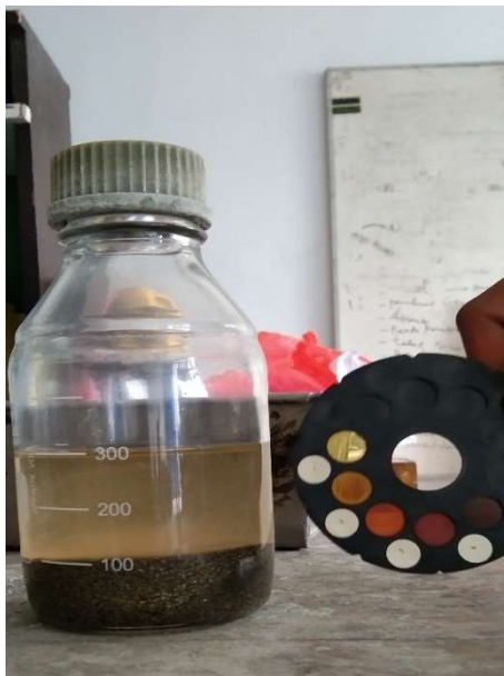
Pemeriksaan kadar organik agregat halus pasir
