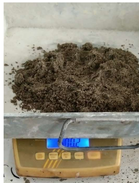
Pemeriksaan kadar air agregat
