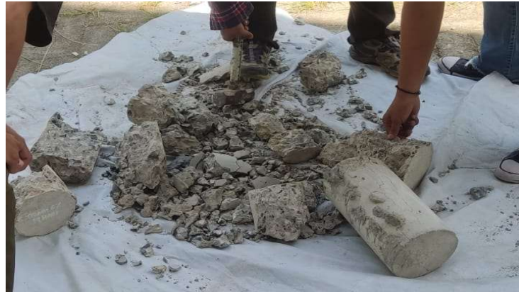
Gambar 2. 4 Limbah Beton (Sumber : Dokumentasi pribadi)
