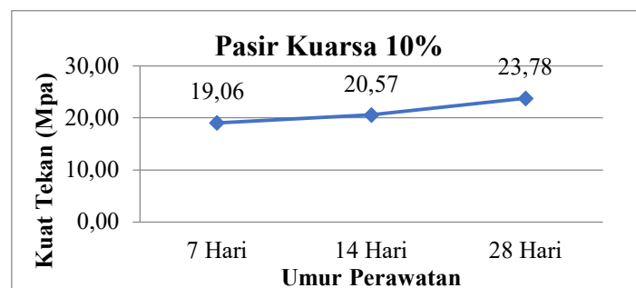
Gambar 4. 6 Grafik pengujian kuat tekan beton PSK 10% (Sumber: Hasil olah data)
