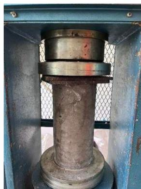
**Gambar 2.4** Alat Uji Kuat Tekan Beton
