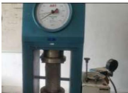
**Gambar 2.5** Pengujian Kuat Tekan Pada Beton
