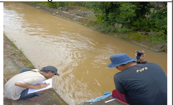
Pengambilan data kecepatan air di tengah Ruas B.J. 5 -B.Ulo 1
