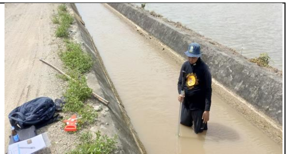
Pengambilan data kecepatan air di tengah B.Mar 2 -B.Mar.3
