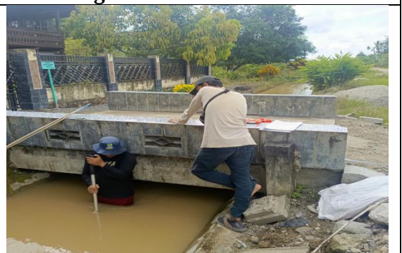
Pengambilan data kecepatan air di tengah Ruas B.Mr 1
