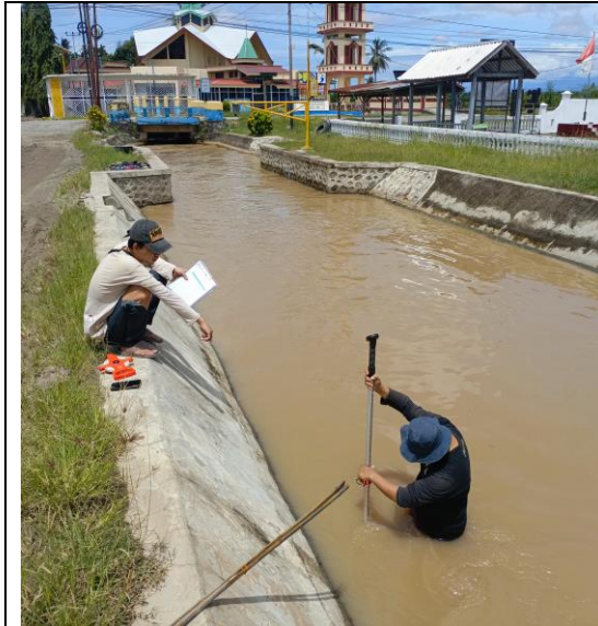
Pengambilan data kecepatan air dititik pinggir Ruas B.J.5 -B.J.6
