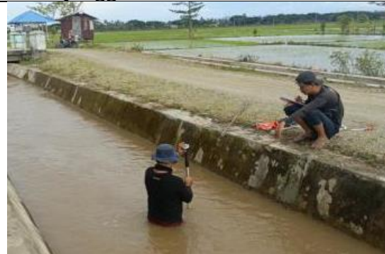
Pengambilan data kecepatan air dititik pinggir Ruas B.Mar 1 -B.Mar.2
