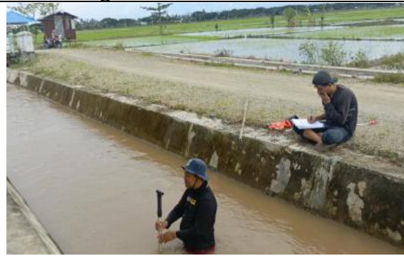
Pengambilan data kecepatan air di tengah Ruas B.Mar 1 -B.Mar.2
