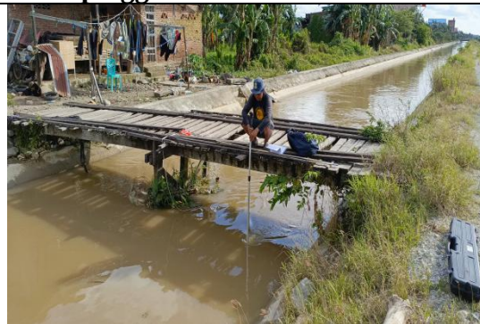
Pengambilan data kecepatan air dititik pinggir Ruas B.J.1 -B.J.2
