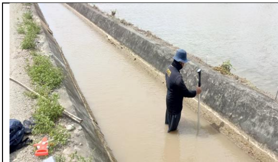
Pengambilan data kecepatan air dititik pinggir B.Mar 2 -B.Mar. 3
