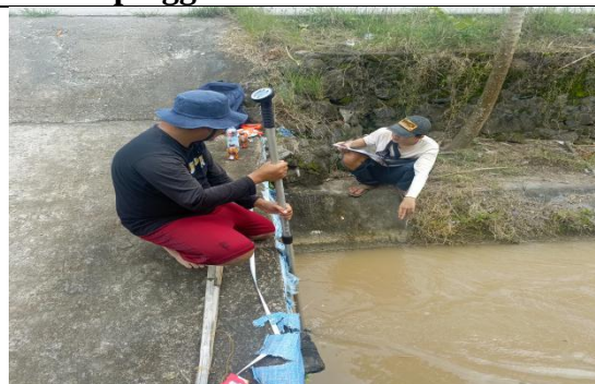
Pengambilan data kecepatan air dititik pinggir Ruas B.J. 5 -B.Ulo 1
