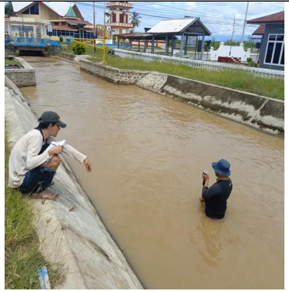
Pengambilan data kecepatan air di tengah Ruas B.J.5 -B.J.6
