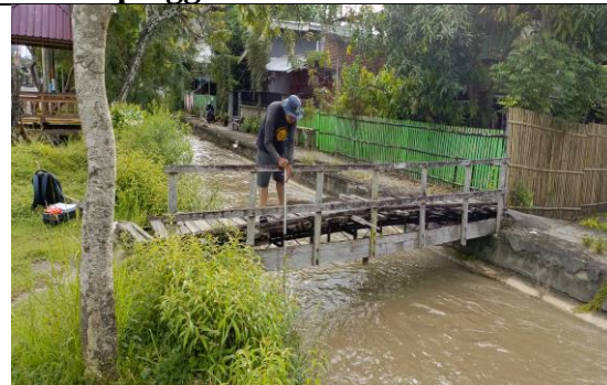
Pengambilan data kecepatan air dititik pinggir Ruas B.Sa 10 -B.J.1
