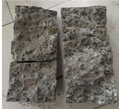
Gambar 7. Tarik belah beton campuran limbah rigid 20%
