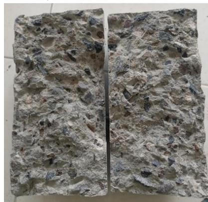
Gambar 8. Tarik belah beton campuran limbah rigid 20% + bestmittel 0,5%
