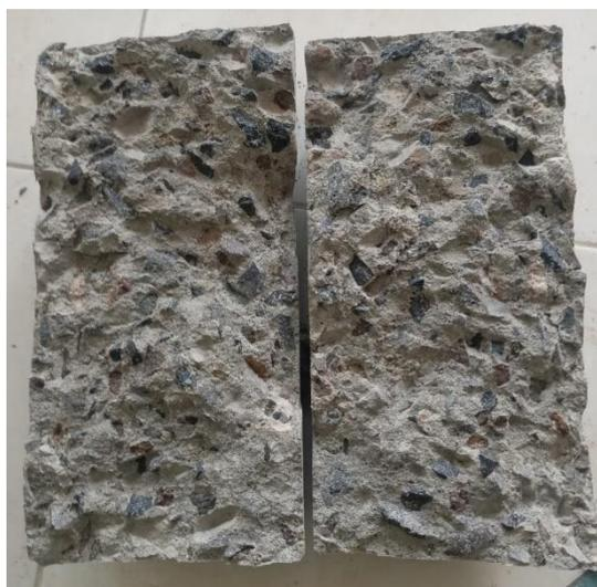
**Gambar 4. 9** Tarik belah beton campuran limbah rigid 20% + bestmittel 0,5%
