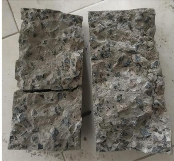
**Gambar 4.8** Tarik belah beton campuran limbah rigid 20%
