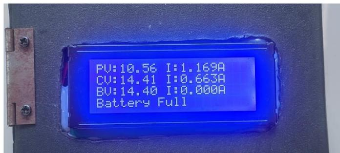
**Gambar 4. 7** Pengujian over voltage
