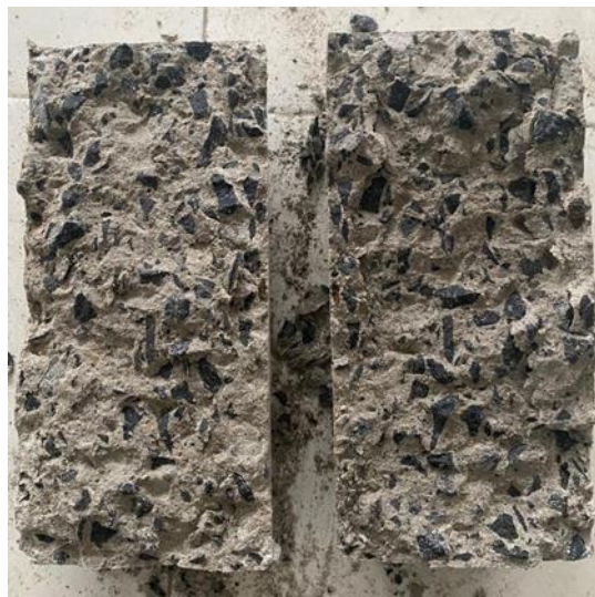
Gambar 10. Tarik Belah Beton Serat Fiberglass 1,5%
