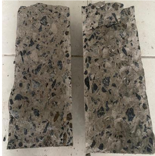
Gambar 7. Tarik Belah Beton Normal
