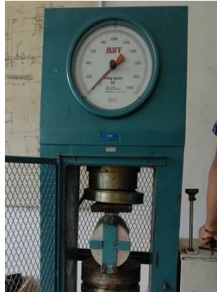
Gambar 3. Kuat Tarik Beton
