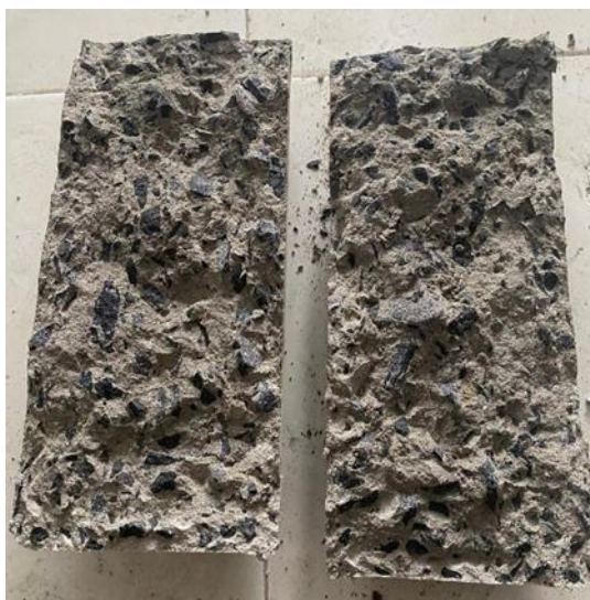
Gambar 8. Tarik Belah Beton Serat Fiberglass 0,5%
