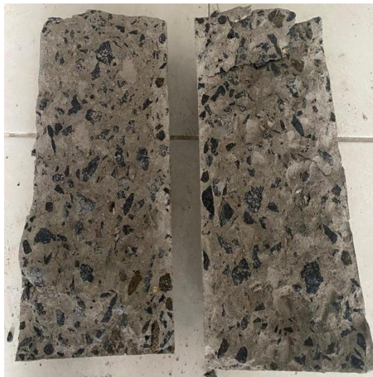
Gambar 4. 7 Gambar tarik belah beton normal (Sumber : Dokumentasi pribadi)
