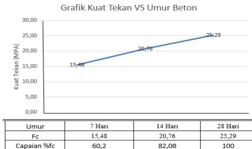
**Gambar 4.2** Grafik Hitung Kuat Tekan Fc Umur Beton
