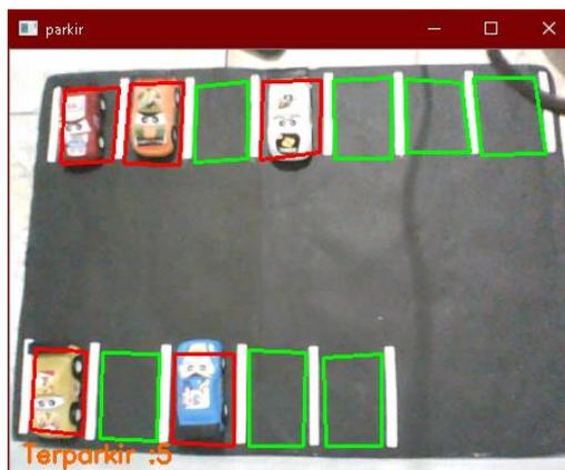
Gambar 10. Tampilan Berhasil membuka webcam dan menghitung kendaraan
