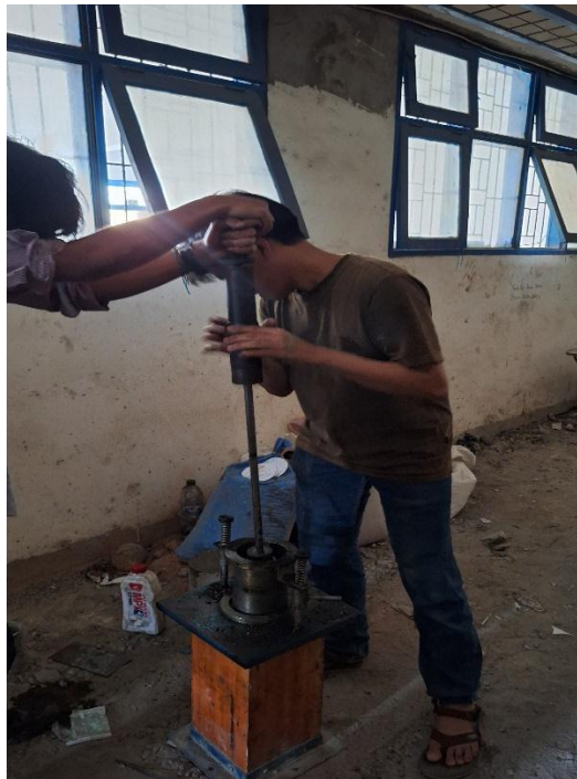
Proses pembuatan briket
