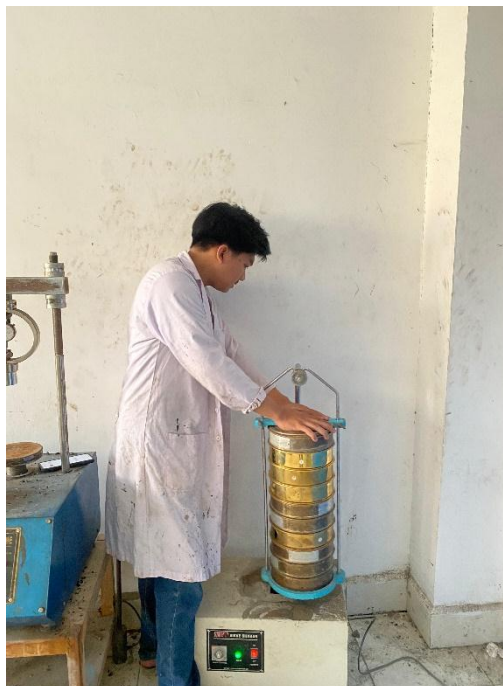
Proses uji agregat analisa saringan
