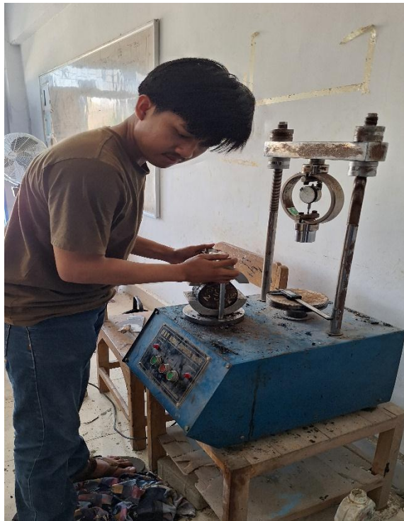
Proses pengujian Marshall
