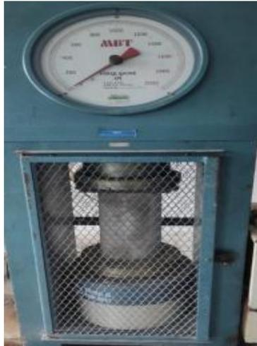
Gambar 3. Pengujian kuat tekan dimesin *Compression Testing*
