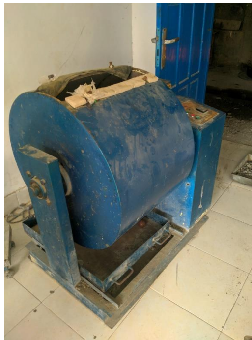
Pengujian agregat menngunakan mesin loss angeles
