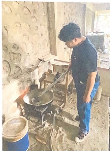
Proses pencampuran aspal dan agregat
