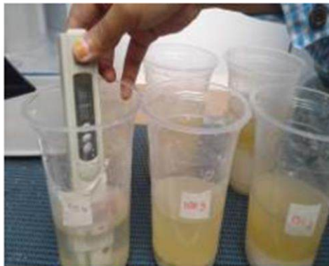
Gambar 19. Percobaan larutan garam non yodium menggunakan sensor kalibrator TDS Meter
