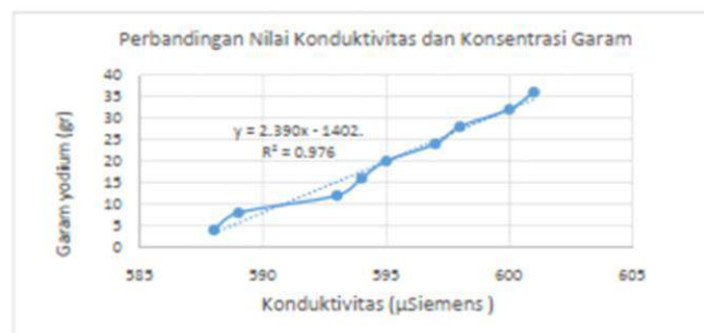
Grafik 4. Karakteristik nilai konduktivitas sensor kalibrator conductivity meter terhadap konsentrasi garam (uji konduktivitas)
