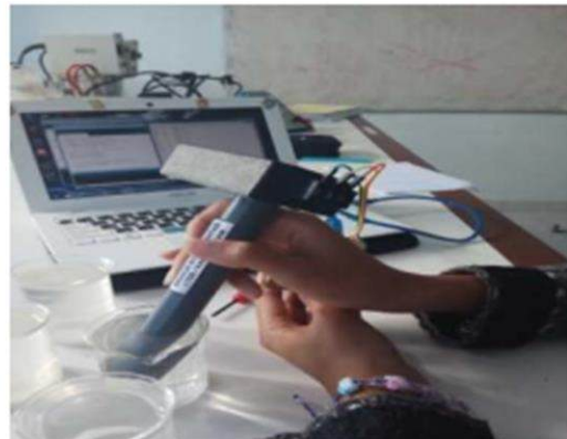
Gambar 13. Percobaan larutan garam yodium menggunakan sensor uji
