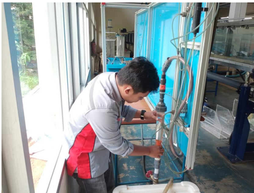
Memastikan tidak ada gelembung udara yang masuk pada tabung manometer
