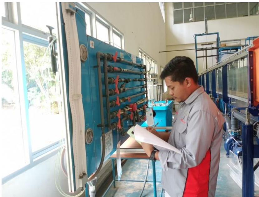
Mencatat debit air yang masuk ke jaringan pipa
