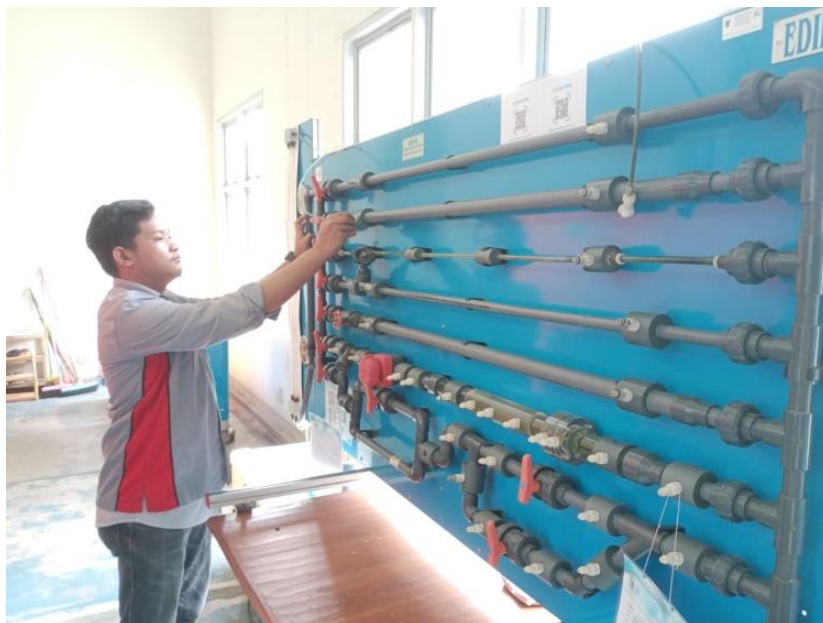
Mengulang percobaan dengan jenis diameter pipa yang berbeda
