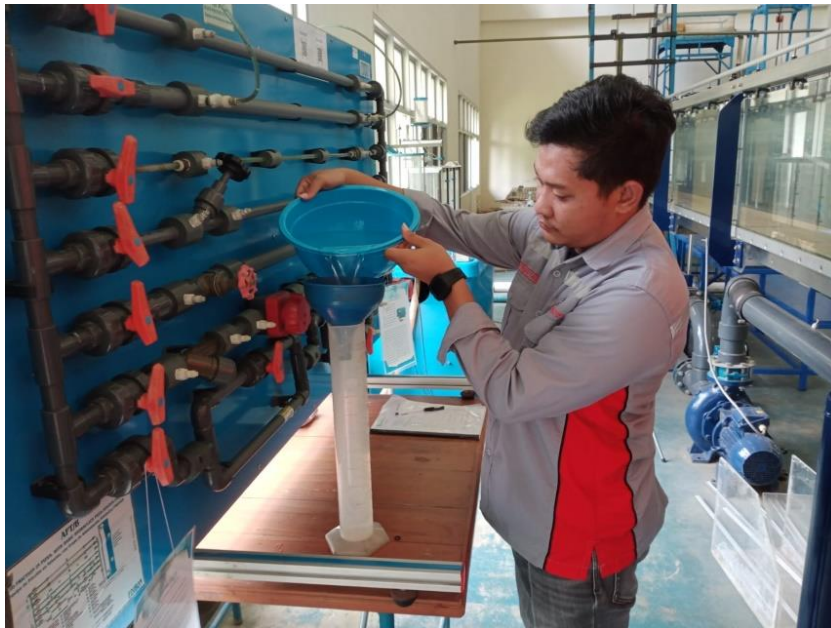
Menuangkan air yang di wadah ke dalam gelas ukur
