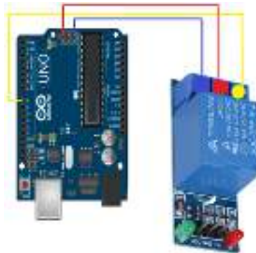
Gambar 3. Rangkaian alur ino ke relay
