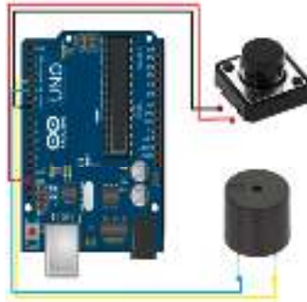
Gambar 2. Rangkaian alur uno, Button Dan Buzzer
