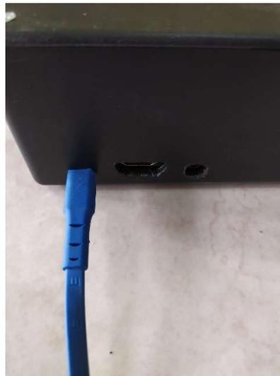
**Gambar 4. 29.** Memasang kabel *power usb*
