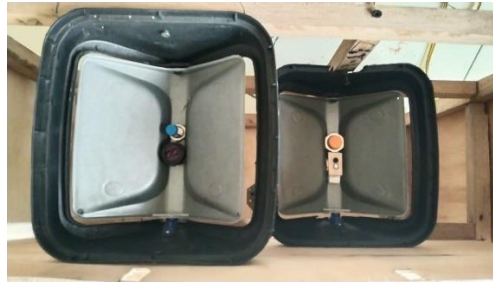
Gambar 4. 11 Penempatan Sensor Proximity di Dalam Box
